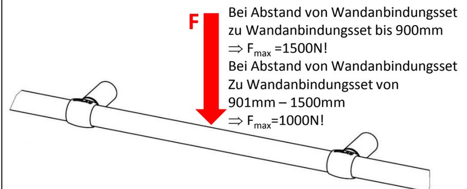
CE-Konform nach 93/42/EWG und geprüft nach DIN EN 12182 sowie ISO 17966 für eine Gebrauchslast von 150 kg bzw. 100 kg und über eine Lebensdauer von 22.000 Lastwechseln bzw. 6 Jahren.
