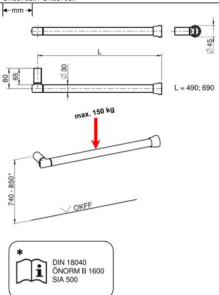
CE-Konform nach 93/42/EWG und geprüft nach DIN EN 12182 sowie ISO 17966 für eine Gebrauchslast von 150 kg und über eine Lebensdauer von 22.000 Lastwechseln bzw. 6 Jahren.
