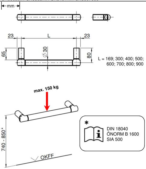
CE-Konform nach 93/42/EWG und geprüft nach DIN EN 12182 sowie ISO 17966 für eine Gebrauchslast von 150 kg und über eine Lebensdauer von 22.000 Lastwechseln bzw. 6 Jahren.
